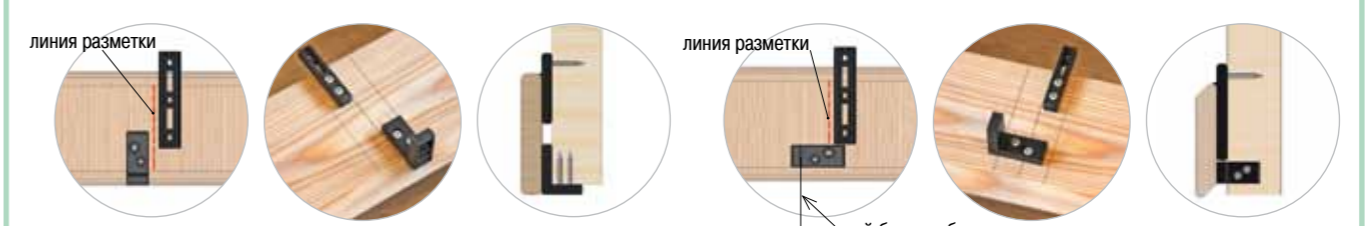
Вариант 1 – ТОРЦЕВОЕ крепление стартового крепежа Вариант 2 – БОКОВОЕ крепление стартового крепежа
